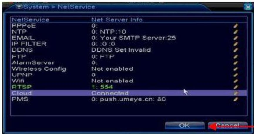
در صورتی که عباراتی مانند **connecting** (در حال اتصال) و یا **not connect** (متصل نیست) را مشاهده کردید، یعنی که دستگاه به اینترنت متصل نشده است که احتمال زیاد در صورت اطمینان از سلامت کابل شبکه، IP مودم با دستگاه **DVR** شما هم رنج نمی‌باشد. اما هم رنجی را به چه صورت انجام دهیم؟ برای تنظیمات مودم خود باید از طریق یک سیستم کامپیوتری و یا یک لپ تاپ به مودم خود وصل شوید. بدین صورت که آدرس **IP** مودم خود را که اصولاً:
