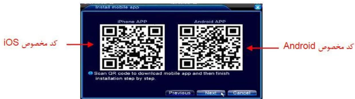
دقت نمایید در برخی از برندها شما از همین صفحه تنظیمات **P2P** ، می‌توانید نرم‌افزار انتقال تصویر را نیز از طریق همان **QR CODE** خوان اسکن و نصب نمایید . به شکل زیر نگاه کنید :
